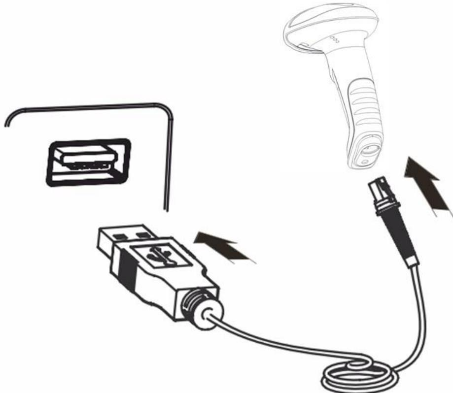
1. 将 USB 数据线的设备接口端 (RJ45 接口) 与 HR22 相连;
